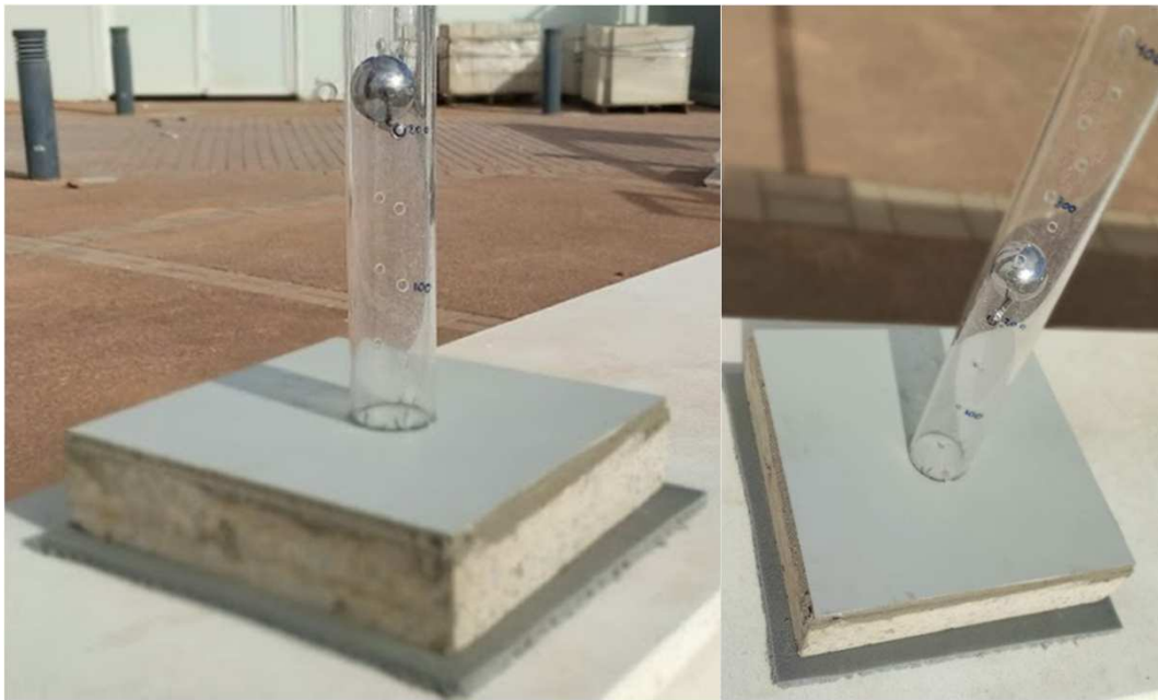
"Détermination de la tenue au choc lourd des carreaux céramiques non émaillés-choc à la bille de 510 g".
