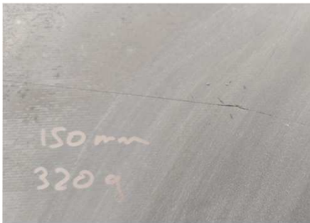
Rotura de la muestra L 3 desde 150 mm .
